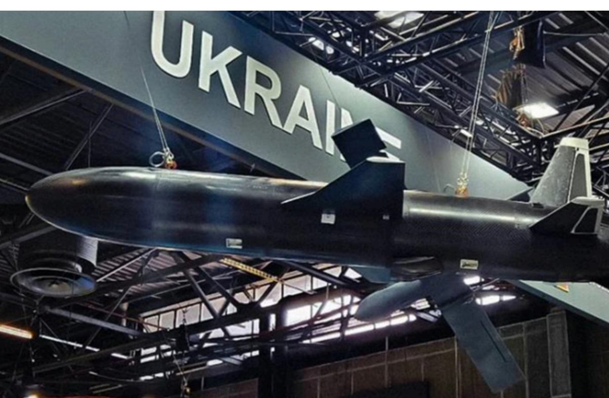
Фото: Оборонка Дрон-камікадзе з турбореактивним двигуном UAV-290
