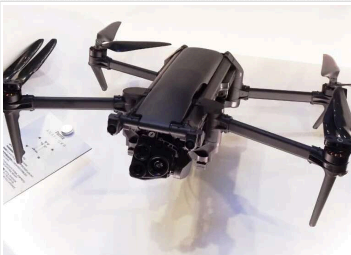
Parrot представила в Парижі компактний розвідувальний дрон ANAFI UKR для ЗСУ – із захищеним зв'язком і 50 хвилинами польоту
