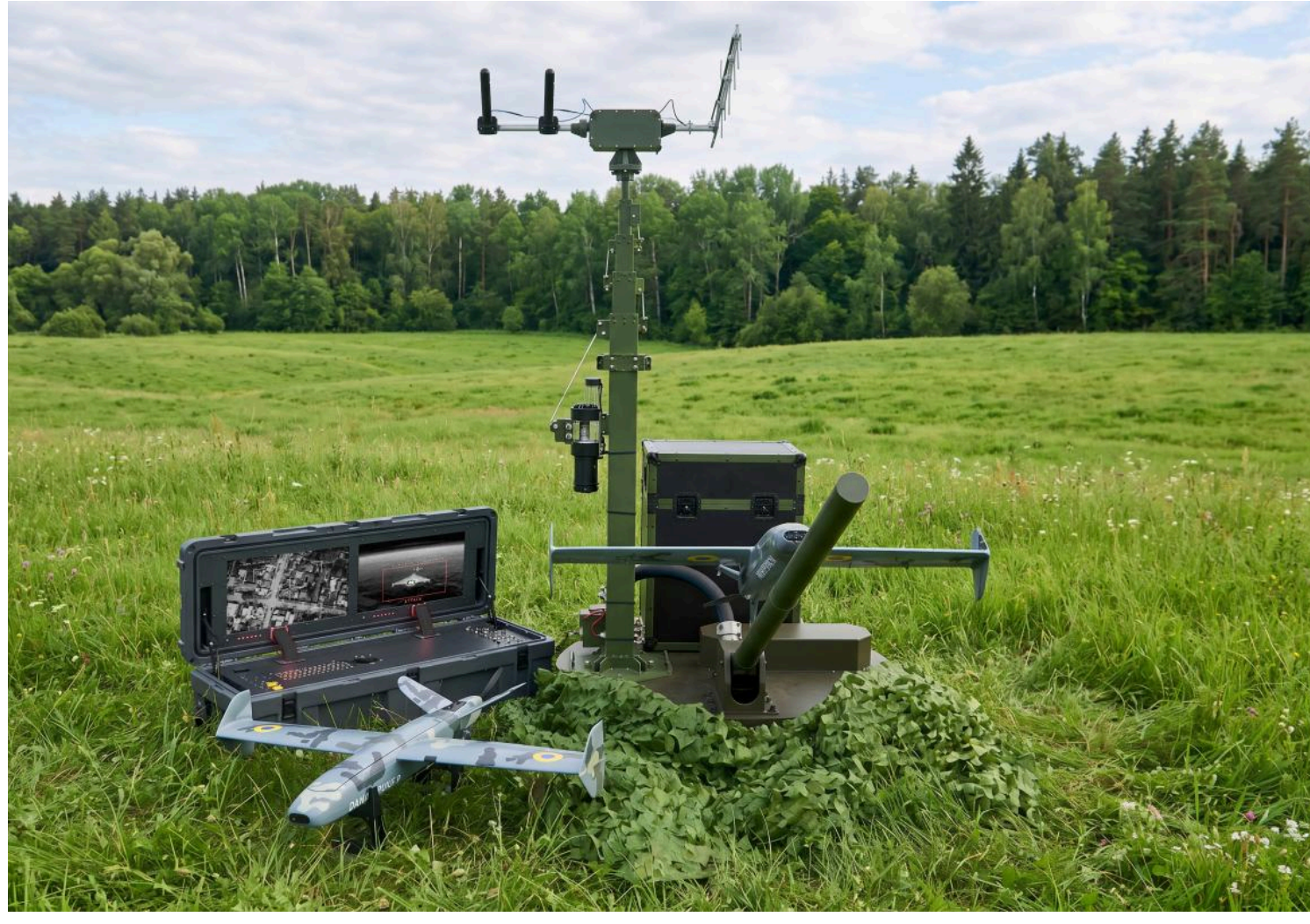
Дрон-перехоплювач призначений для полювання на ворожі БПЛА із швидкістю польоту 450 км/год. Фото YARTURA
