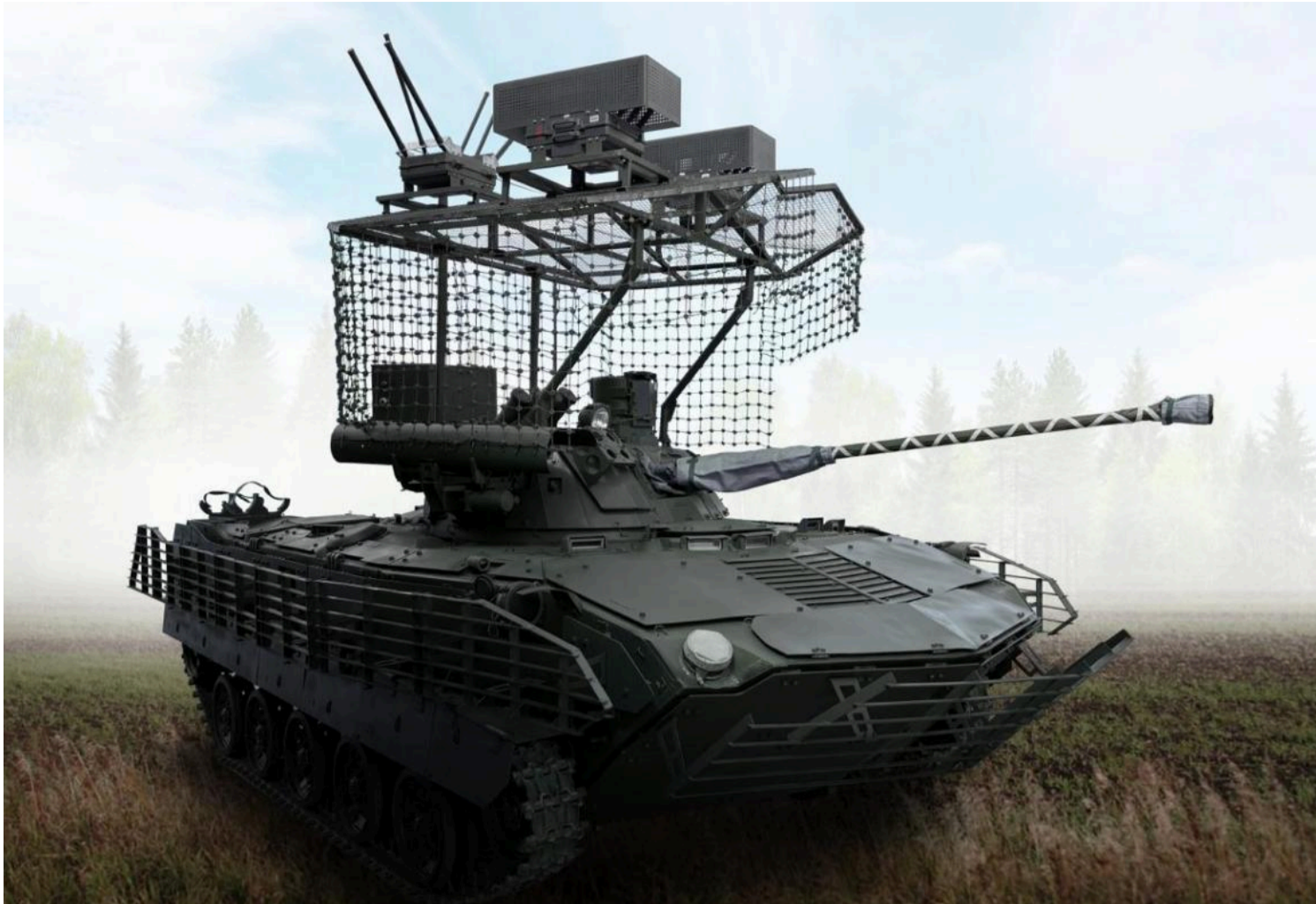
Машина має легку броню, яка захищає лише від куль стрілецької зброї / фото Високоточні комплекси
