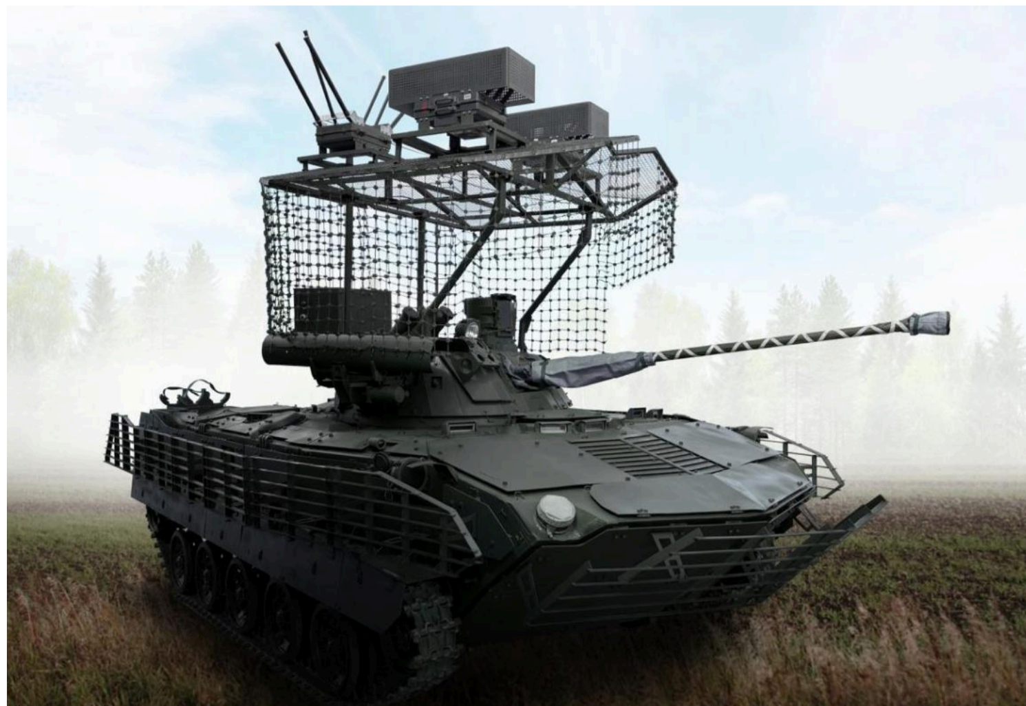
Машина має легку броню, яка захищає лише від куль стрілецької зброї / фото Високоточні комплекси
