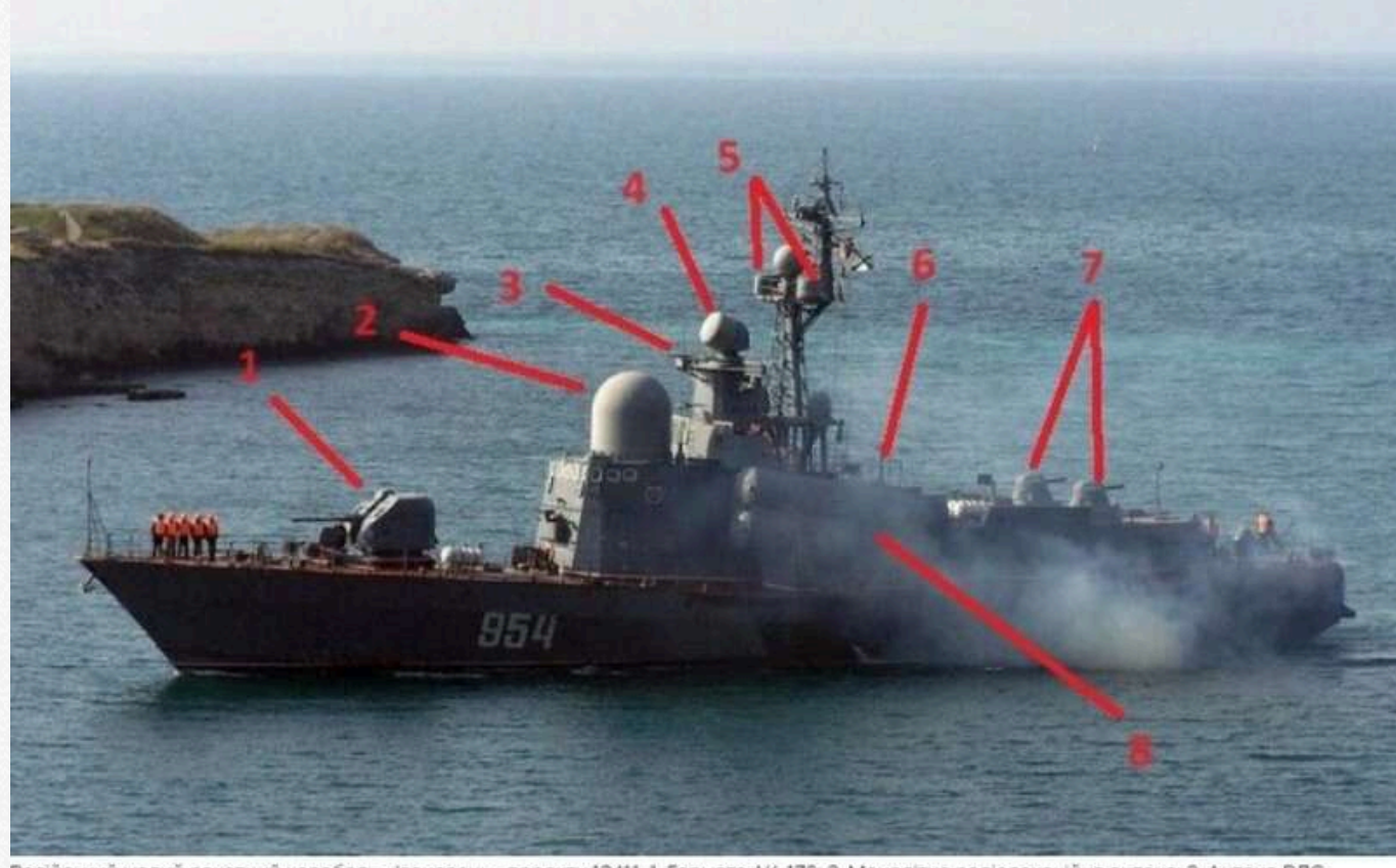
Російський малий ракетний корабель «Івановец» проекту 12411. 1. Гармата АК-176. 2. Монолітна радіолокаційна антена. 3. Антена РЛС "Печора". 4. Антена РЛС МР-123. 5. Антени системи WRE. 6 "Колонок". 7. Гармати АК-630. 8. Лівий борт ракетних установок "Москіт"
