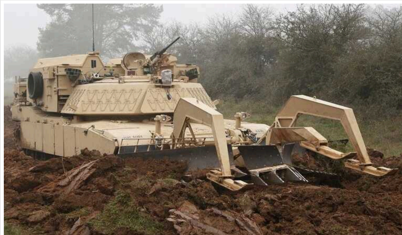
Американська бронемашина-прориву M1150: високомобільний броньований комплекс для подолання мінних полів та загороджень
