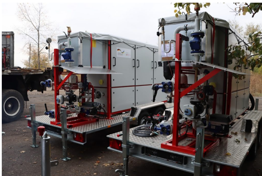
Когенераційні установки. Фото: Златопільська міська рада
